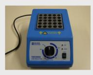
Réacteur de construction robuste, il permet d'effectuer 25 digestions simultanément. La sélection de température permettra d'effectuer la digestion DCO mais également d'autres digestions comme le phosphore total et l'azote total.
