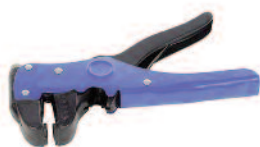
PINCE A DENUDER AUTOMATIQUE Coupe et dénude les fils électriques de 0,2 à 6 mm. Possède un dispositif correcteur de la pression d'incision et deux lames tranchantes pour sectionner les câbles.
